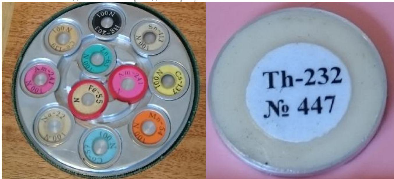
Рисунок 1 – Внешний вид источников ИМН-Г-1 и ИМН-Г-3-Т
