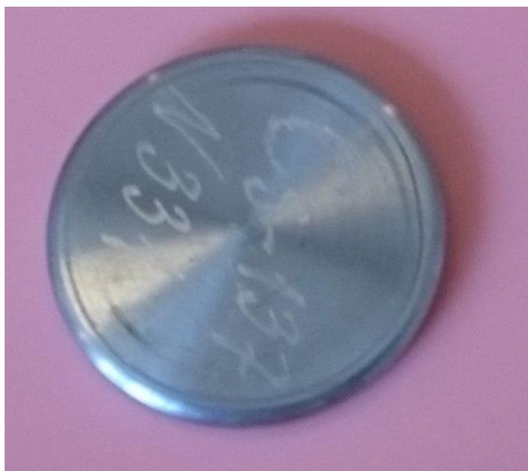
Рисунок 3 – Внешний вид источников ИВГИ и ИМН-Г-3-Т
