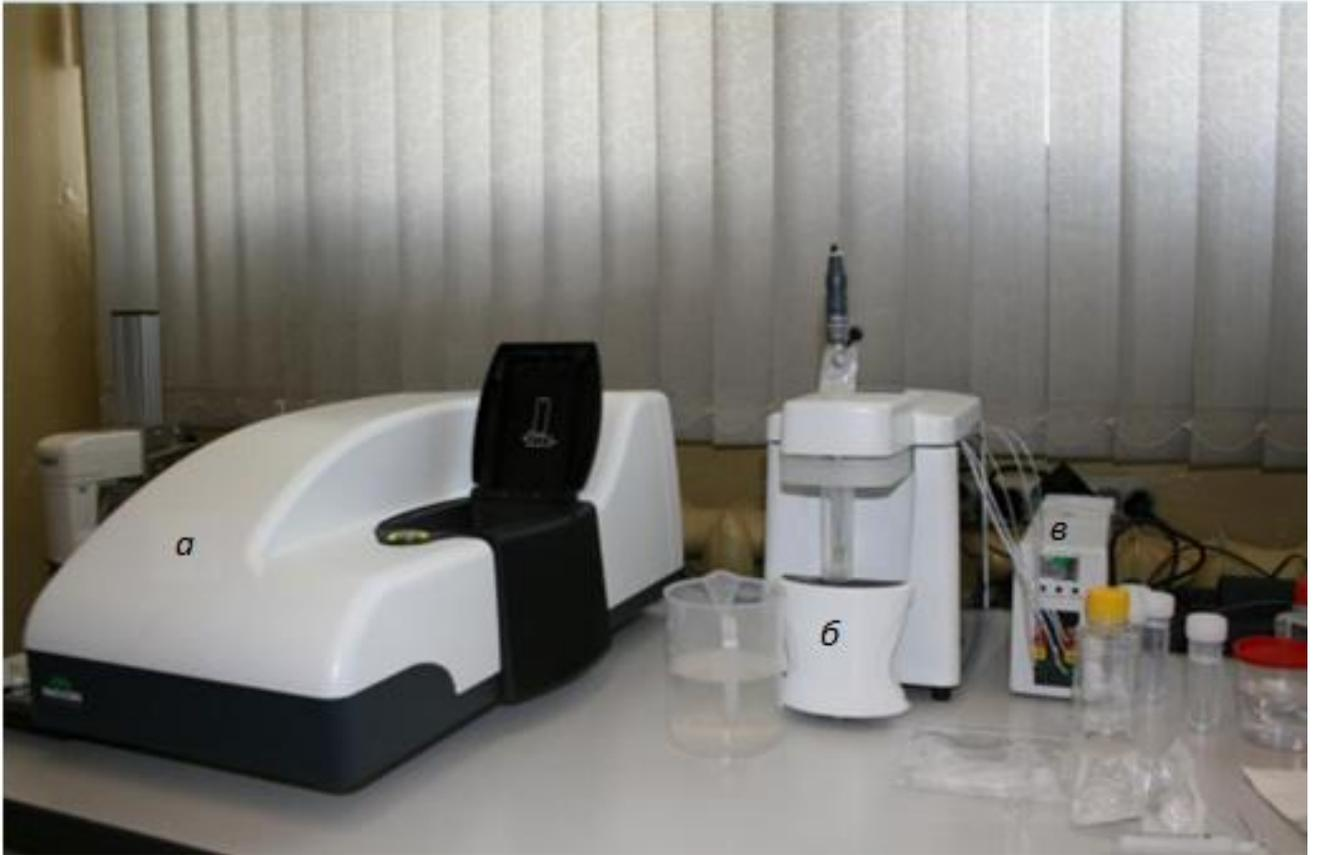
Рисунок 3.2. Составная часть комплекса эталонных средств воспроизведения единицы дзета-потенциала частиц в жидкостях на основе комбинации методов PALS + ELS.
