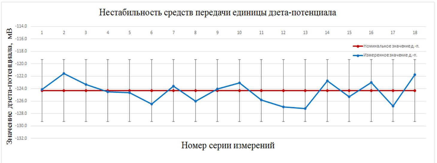
Рисунок 3.24. Максимальная нестабильность метрологических характеристик разработанных средств передачи единицы дзета-потенциала частиц в образце -124,3 мВ
