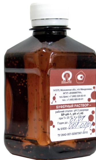
Буферные растворы представляют собой водные растворы химических веществ, которые расфасованы в пластмассовые флаконы. Флакон герметичен и имеет завинчивающуюся крышку с защитным кольцом для предотвращения несанкционированного доступа. Буферные растворы имеют 9 модификаций, отличающихся концентрацией химических веществ и воспроизводимыми значениями рН.
