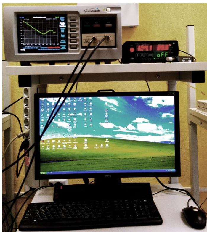
Рисунок 33. Фото системы измерений погрешности передачи ЭСЧ по ВОЛС и мониторинга окружающей среды
