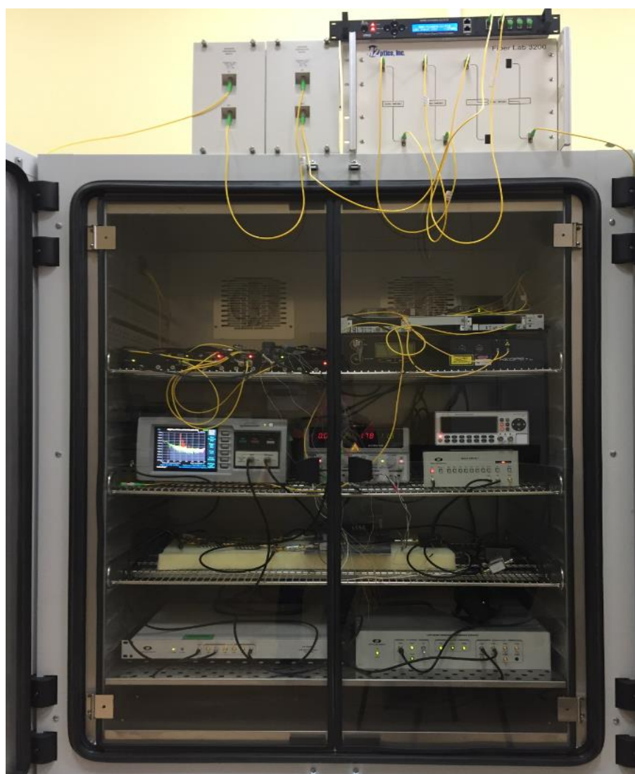
Рисунок 39. Общий вид системы передачи, помещенной в камеру постоянных климатических условий
