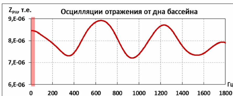
Рисунок 2.19 – Частотная зависимость, искаженная отражением от дна бассейна
