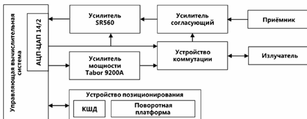
Рисунок 3.1 – Структурная схема стенда для измерений ЧХЧ и ХН ГПУ
