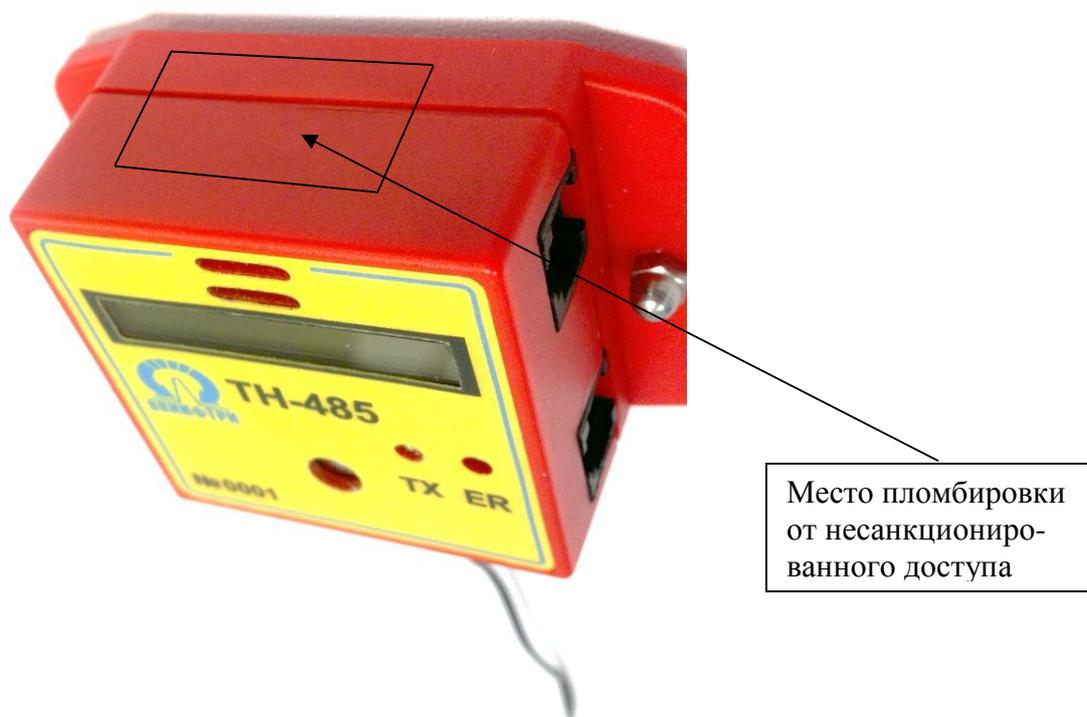
Рисунок 3 - Место пломбировки датчика
