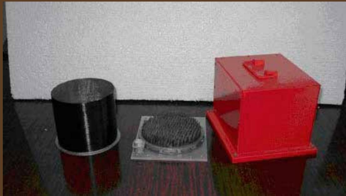
**НАЗНАЧЕНИЕ:** калибровка российских и зарубежных спутниковых МКВ радиометров дистанционного зондирования Земли
