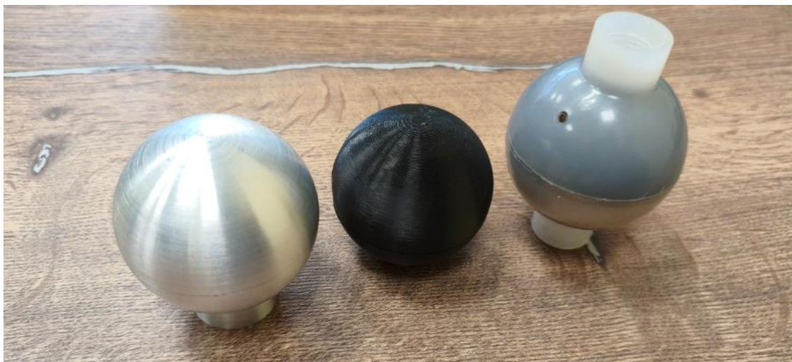
Рисунок 2.5 – Корпуса, ограничивающие эффективный объем ионизационной камеры, изготовленные из полиэтилена, алюминия и графита
