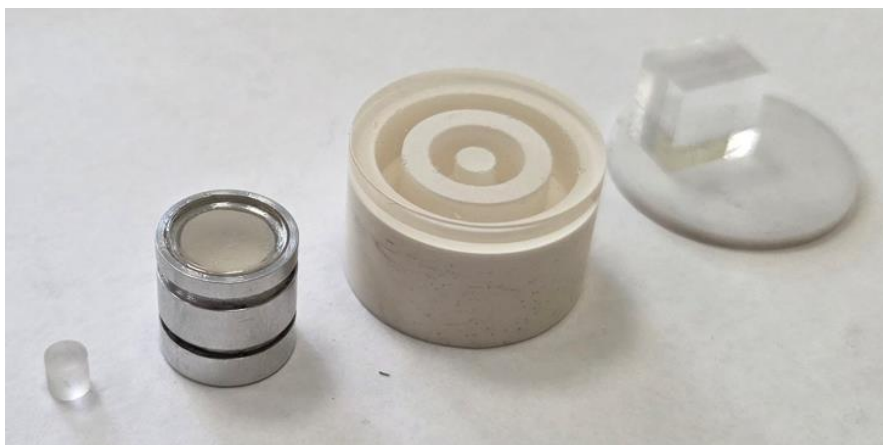
Рисунок 4.8 – Набор сцинтилляционных детекторов
