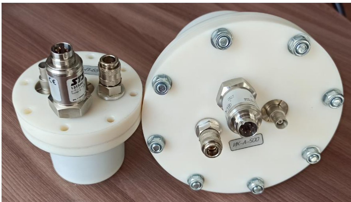
Рисунок 2.6 – Внешний вид ионизационных камер
