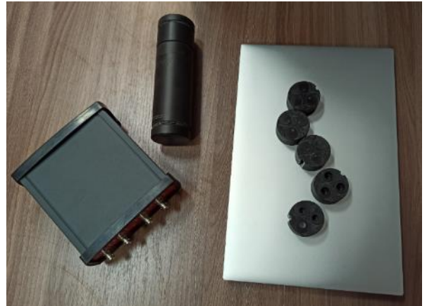
Рисунок 3.4 – Блок регистрации со сменными колпачками с комплексом измерительной аппаратуры
