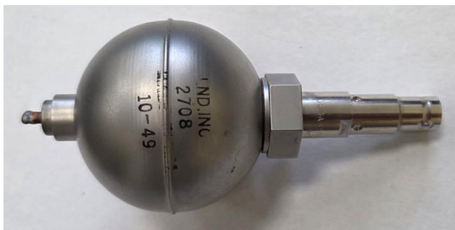
Рисунок 4.6 – Блок регистрации на основе пропорционального счетчика \text{BF}_3
