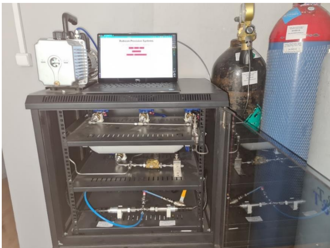
Рисунок 2.2 – Стенд прецизионного заполнения камер газами
