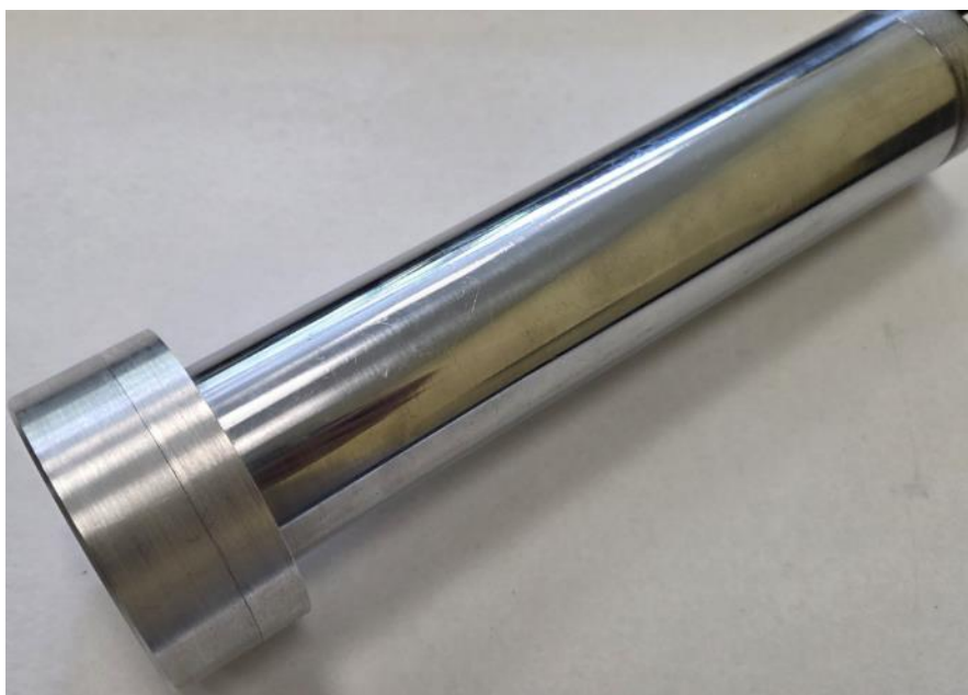
Рисунок 4.9 – Блок регистрации на основе сцинтилляционного детектора \text{ZnS}(\text{Ag})/\text{LiF}
