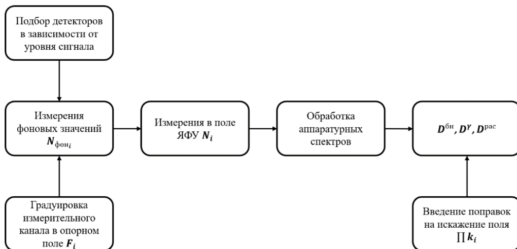
Рисунок 6 – Схема передачи мощности поглощенной дозы нейтронного излучения на ЯФУ
