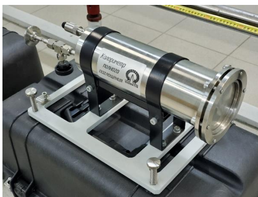
Рисунок 6.8 – Калориметр полного поглощения и медные поглотители
