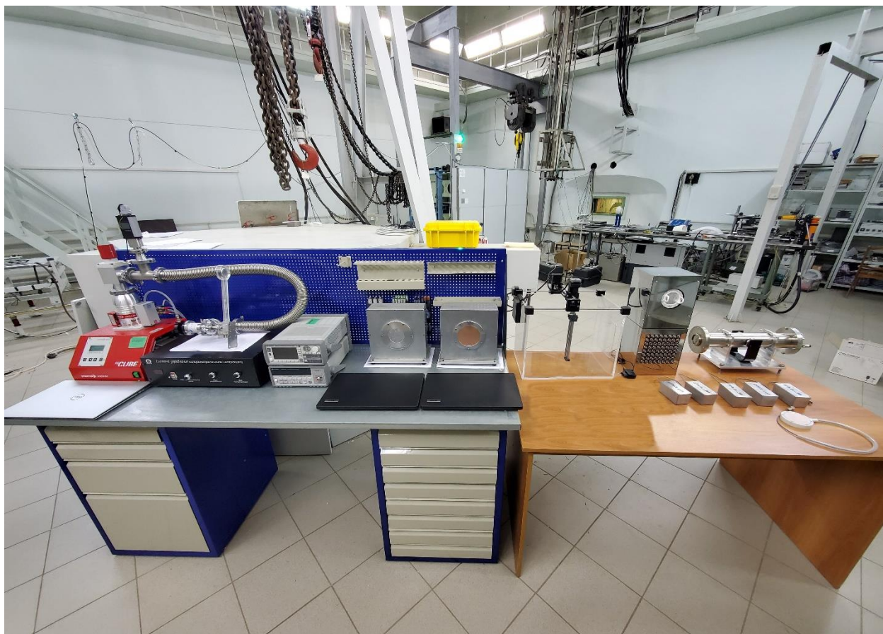
Рисунок 5.11 – Общий вид разработанного комплекса эталонной аппаратуры для измерения параметров пучков протонов и тяжелых заряженных частиц
