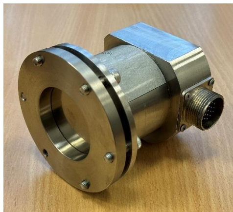
Рисунок 6.7 – Калориметр полного поглощения для частиц с малыми пробегами, конструкцией крепления поглотителей
