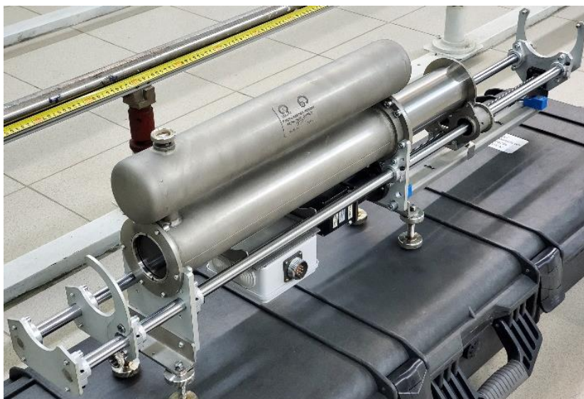
Рисунок 7.16 – Устройство поглотителя переменной толщины
