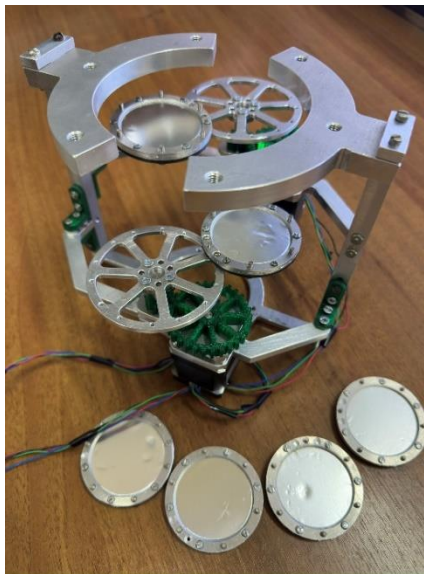
Рисунок 7.18 – Внешний вид конструкции устройства для смены фильтров.
