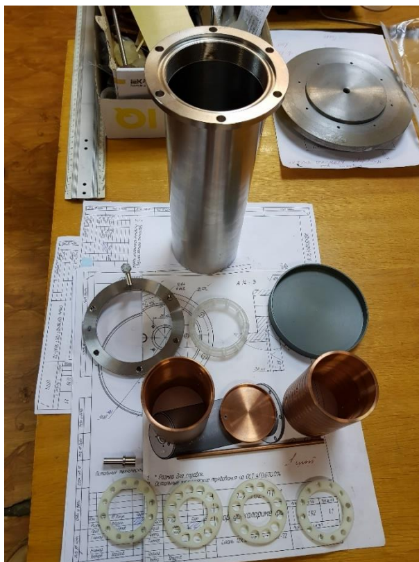
Рисунок 5.6 – Малый цилиндр Фарадея и коллиматоры
