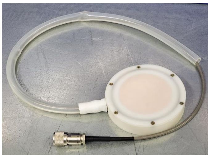
Рисунок 5.8 – Разработанные ионизационная камера и многослойный ЦФ с возможностью изменять материал и толщину слоев
