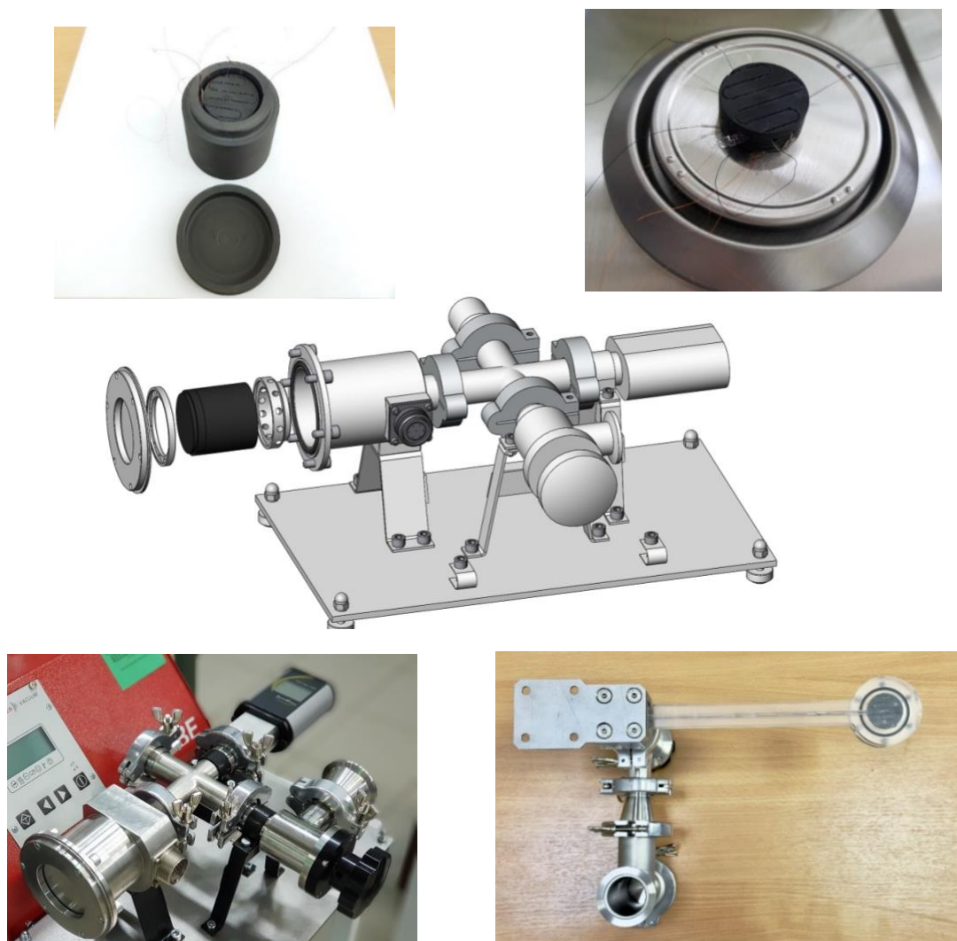
Рисунок 5 – Внутренние элементы конструкции, трехмерная модель и общий вид протонных калориметров
