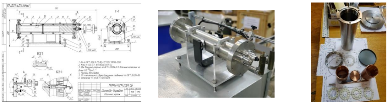
Рисунок 13 – Сборочный чертеж, общий вид и внутренние элементы ЦФ
