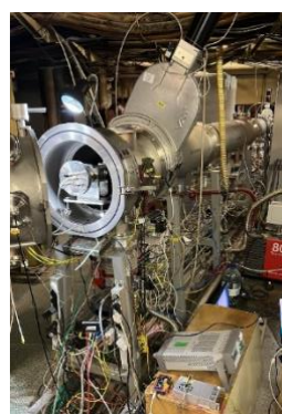
Рисунок 19 – Экспериментальная проверка калориметров полного поглощения и устройств поглотителей переменной толщины
