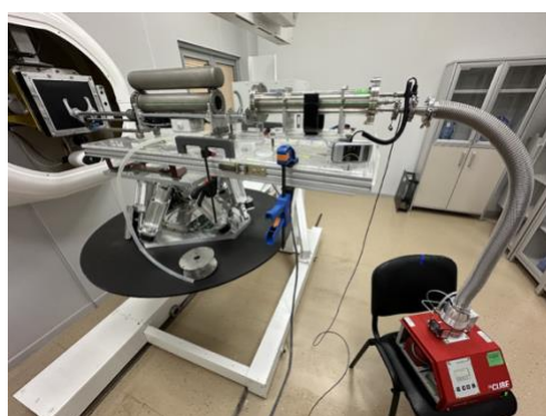
Рисунок 19 – Экспериментальная проверка калориметров полного поглощения и устройств поглотителей переменной толщины
