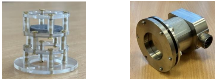
Рисунок 15 – Конструкция держателя поглотителей и общий вид калориметра полного поглощения для тяжелых ионов
