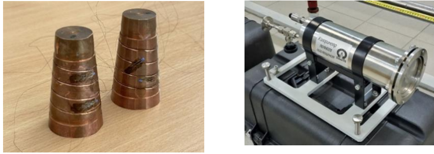
Рисунок 14 – Медный поглотитель и общий вид калориметра полного поглощения
