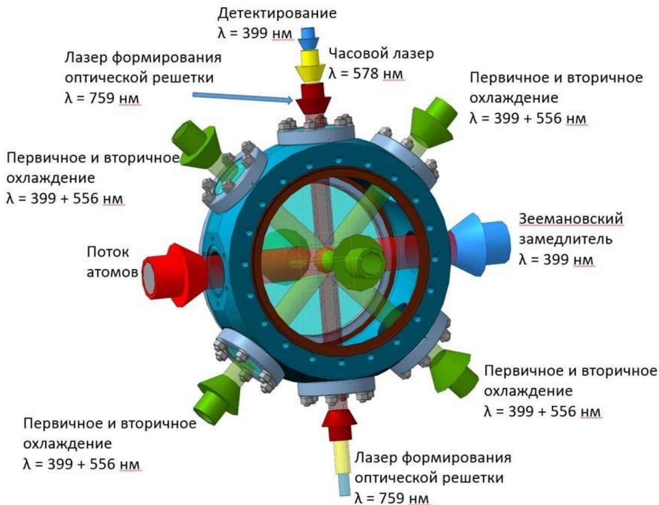
Рисунок 4.3. 3D модель вакуумной камеры с прикрепленными окнами и всеми необходимыми направлениями заведения лазерного излучения.
