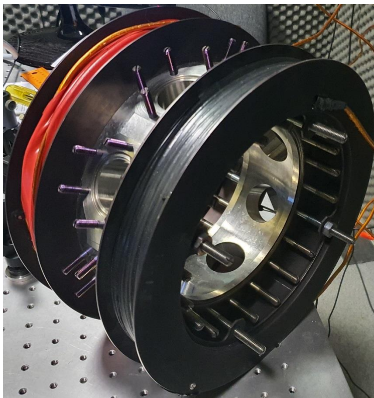
Рисунок 4.9. Пара катушек в анти-Гельмгольц конфигурации для формирования магнитного поля.
